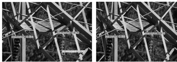
(a) 左(YOLOv5)右(改进的YOLOv5)
